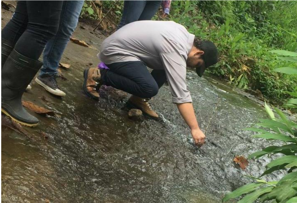
Aforo de río utilizando Q=V*A con el objetivo de confirmar mediciones del transductor de presión
