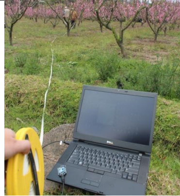
Cinta métrica en medición del alcance de transmisión ZigBee con atenuación de señal
