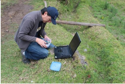
Conexión de la Batería del Nodo Sensor
