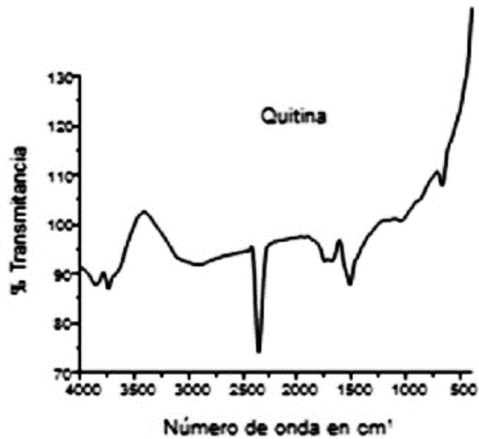
Figura 14. Espectro FTIR de muestra de quitina reportada en bibliografía (Pérez et al., 2014)
