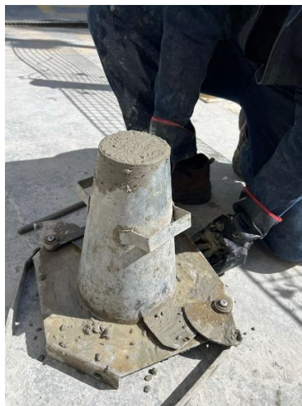
Figura 5.2.1.2. Pruebas de asentamiento de la mezcla
