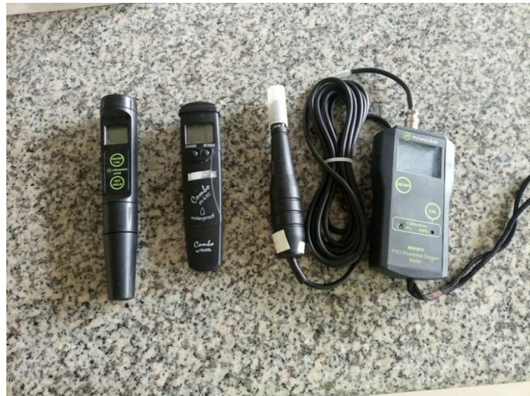
Fotografía 12: Equipos de monitoreo de calidad de agua, O 2 , pH y T°.
