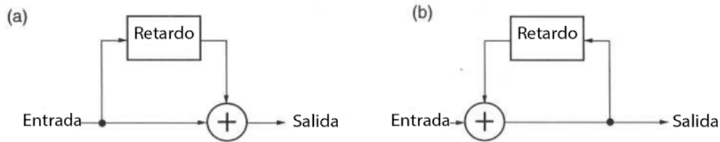
Figura 11: Funcionamiento de Base de un Filtro Digital (GUTIÉRREZ, 2009)
