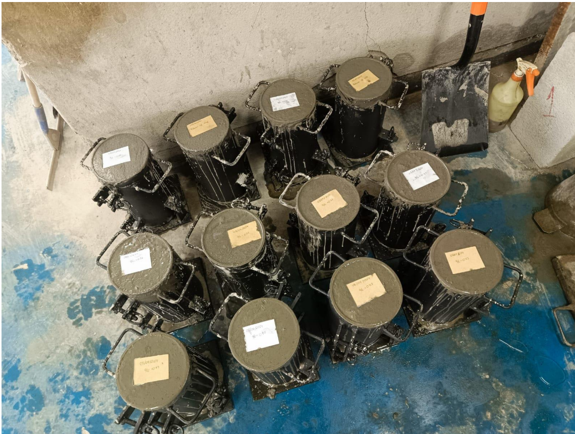
Fabricación de cilindros de hormigón.
