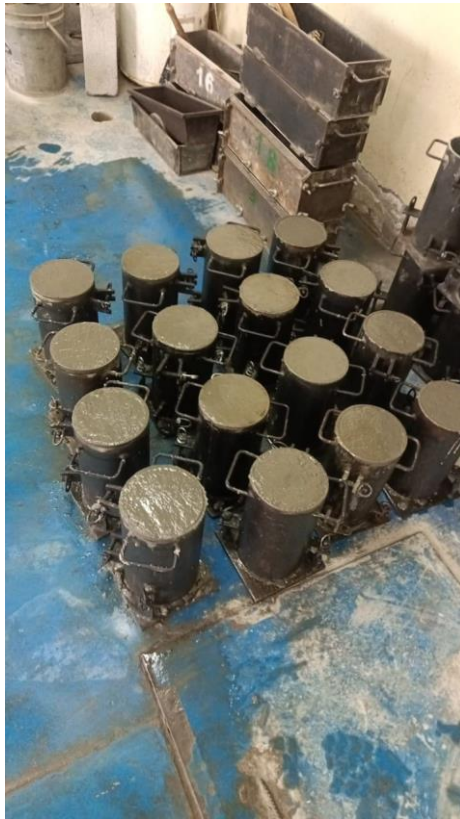
Cilindros de hormigón fabricados con porcentajes de material reciclado.
