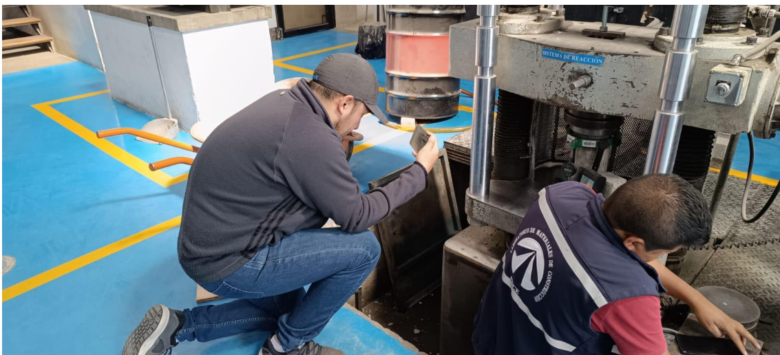
Toma de las deformaciones a la rotura de compresión de la MP, 4%, 8% y 12%.
