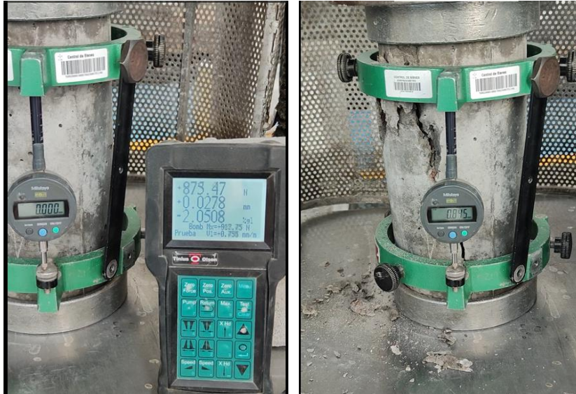
Ensayo de compresión del cilindro de hormigón.
