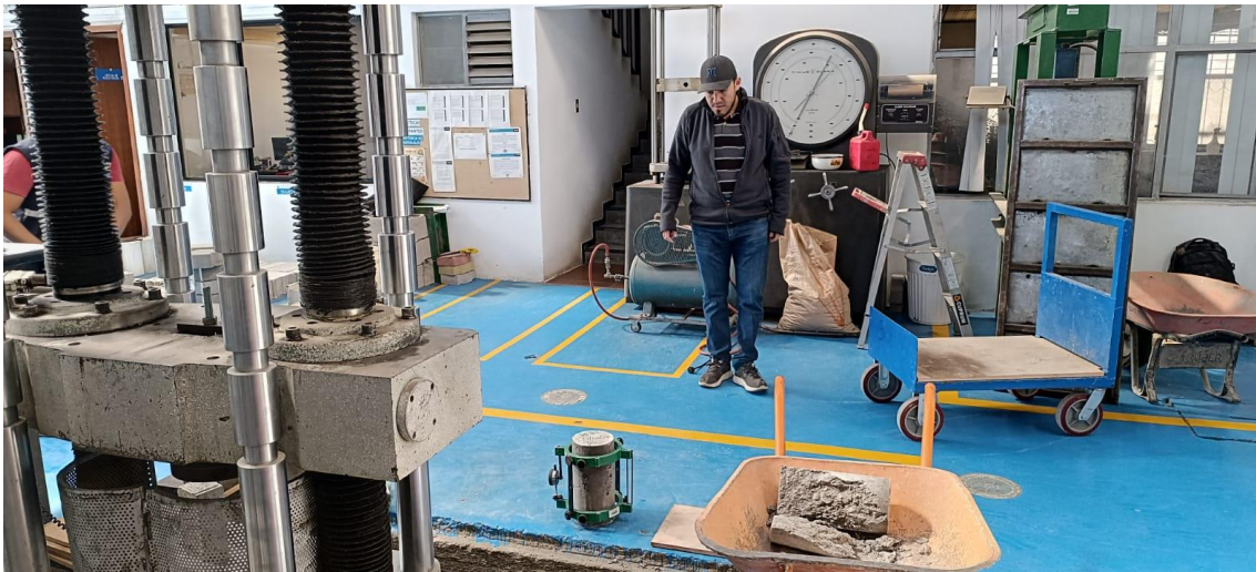
Cilindro de hormigón listo para ensayo de compresión de la MP, 4%, 8% y 12%.
