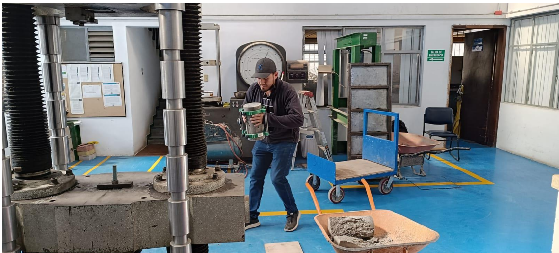
Ensayo de compresión para MP, 4%, 8% y 12%.
