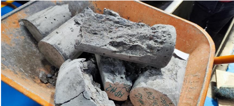
Cilindros de hormigón ensayados.
