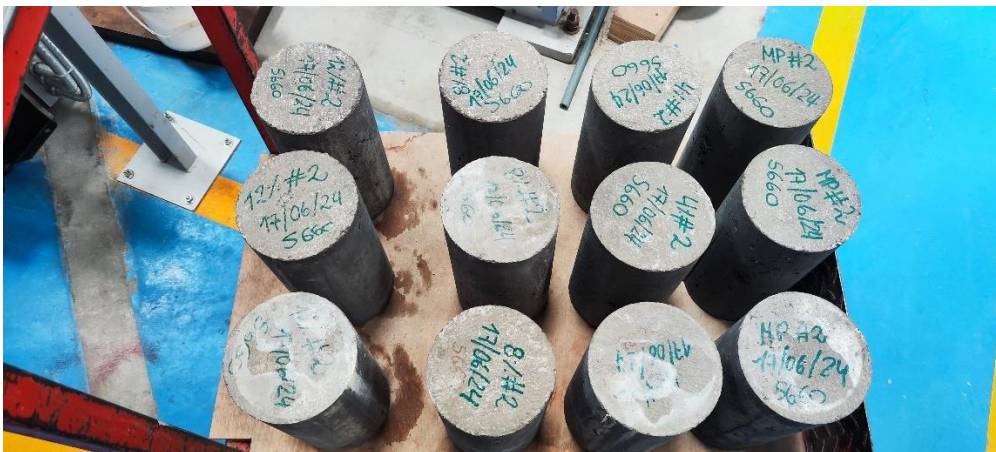
Cilindros de hormigón listos para ensayarlos.
