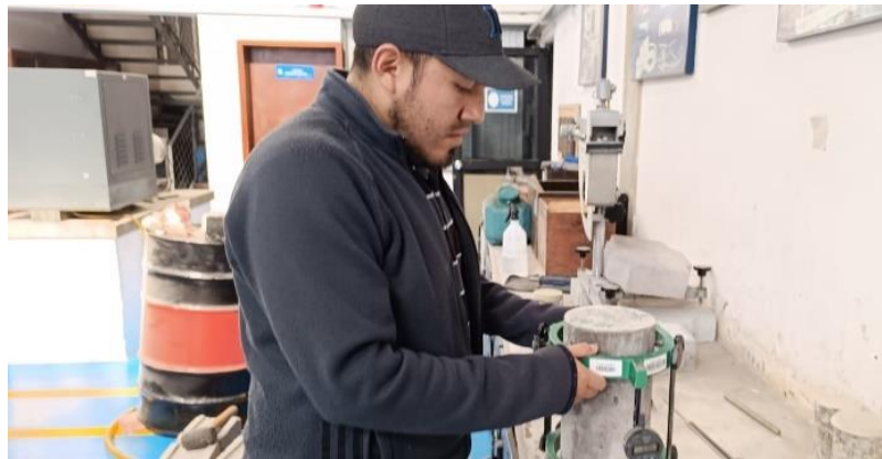
Cilindro de hormigón colocado el compresómetro.
