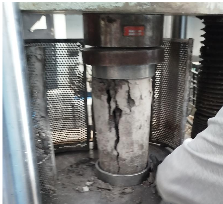
Ensayo de resistencia de cilindros de hormigón.
