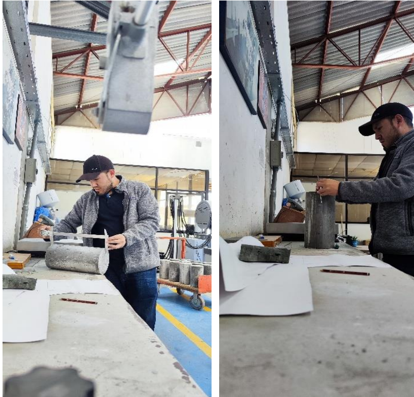
Toma de medidas de cilindros de hormigón.
