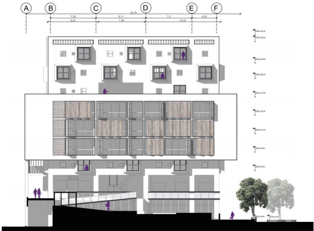
Figura 39 Modulación de la Fachada Fuente: Elaboración Propia
