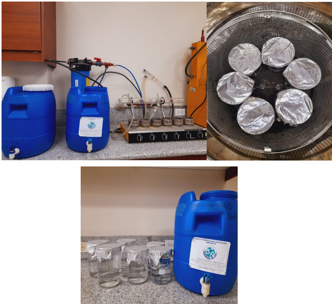
Anexo 12. Proceso de destilación y esterilización a 121 °C del agua para riego.
