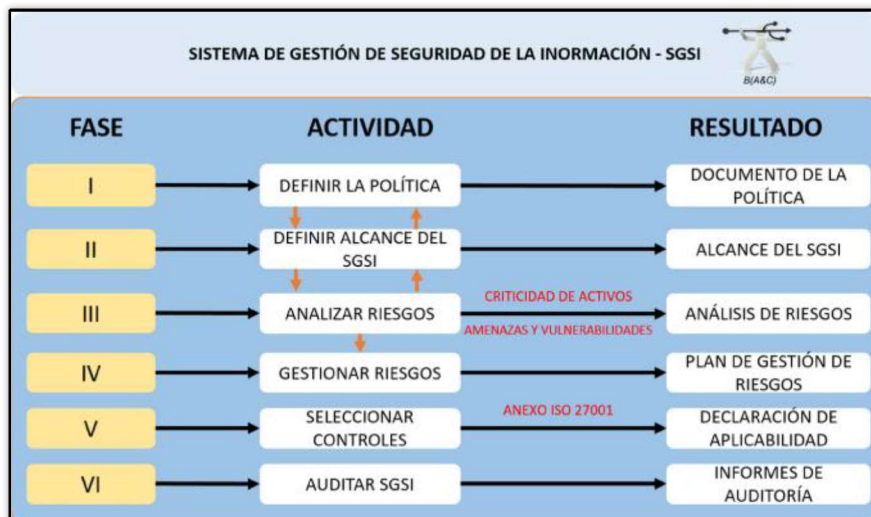
Figura 4: Fases de un Sistema de Gestión de Seguridad de la Información según ISO 27001
