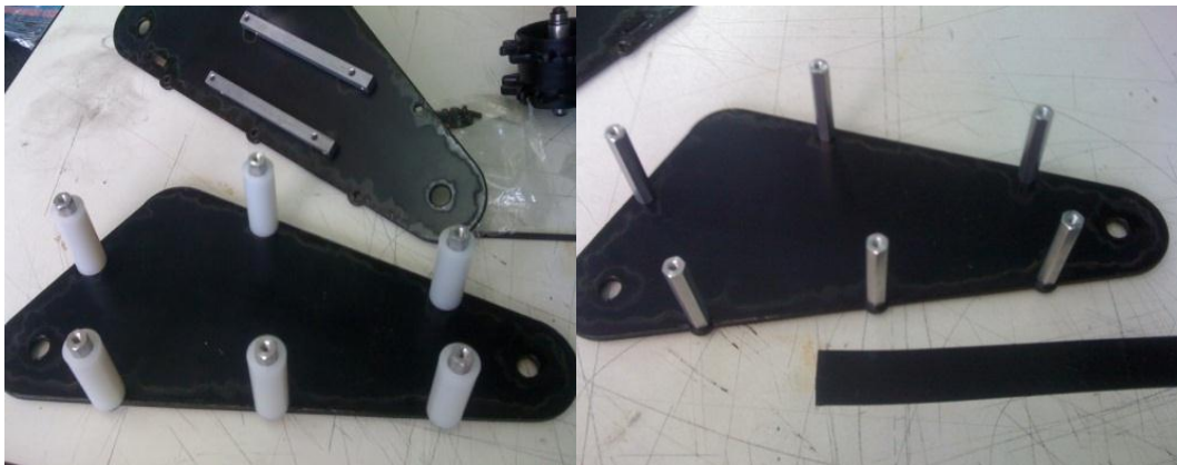
Ilustración 3.13 Colocación de los Separadores
