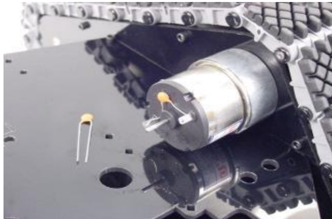
Ilustración 3.23 Colocación de los condensadores
