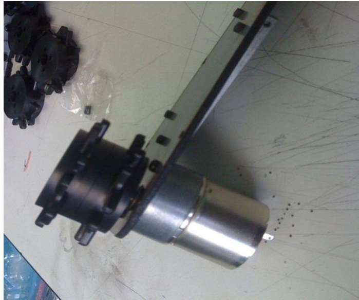
Ilustración 3.15 Colocación de los ejes de los Motores
