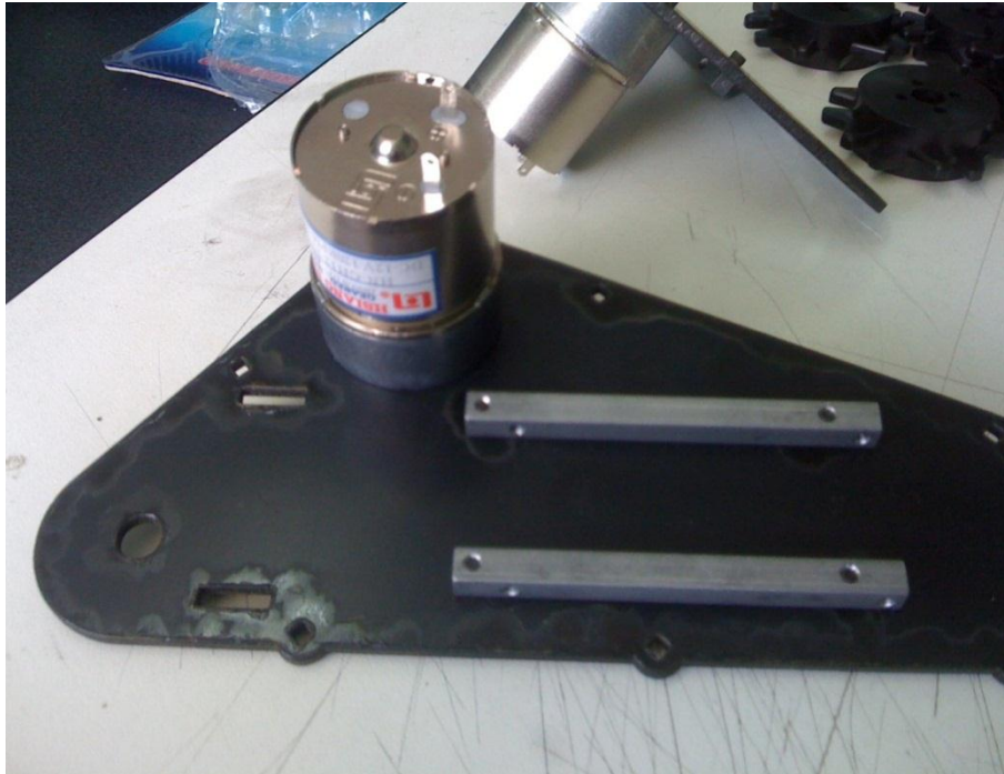
Ilustración 3.14 Colocación de los Motores.
