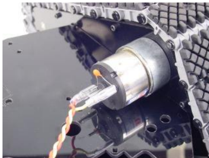
Ilustración 3.24 Unión de los conectores con el motor
