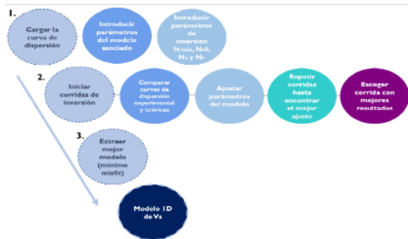
Figura 4-13 Esquema básico del proceso de inversión de curvas de dispersión para obtener modelos 1D de Vs. Modificado de (Mijares Armas, 2019)
