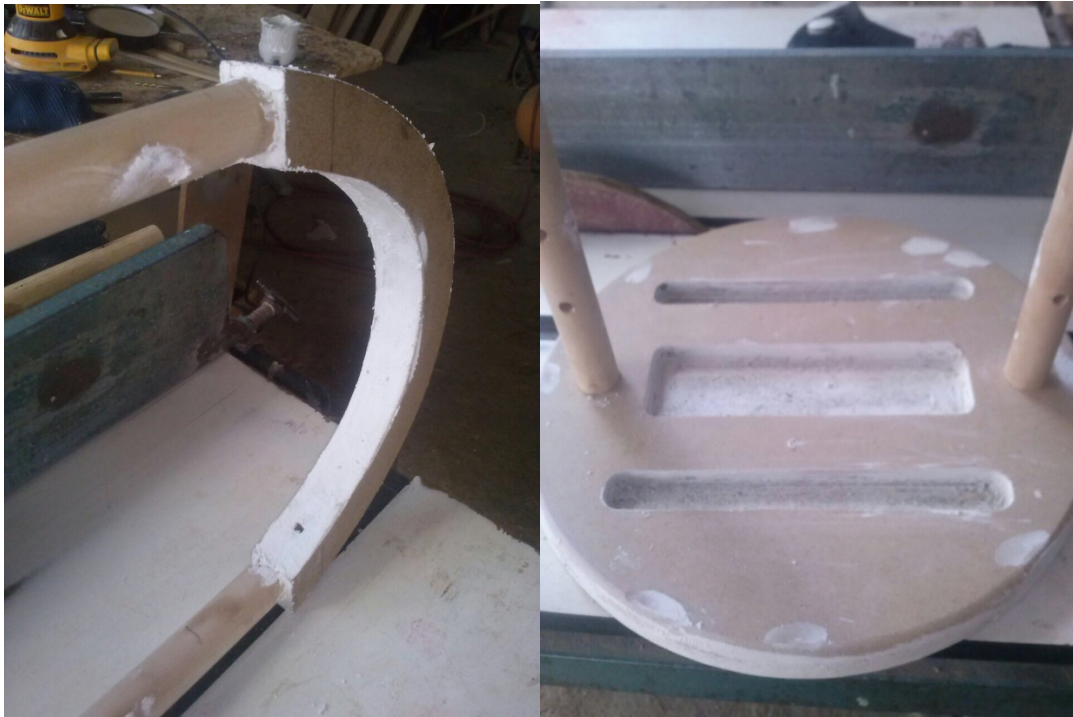
Imagen N38,39: Proceso de masillado. Elaboración propia.
