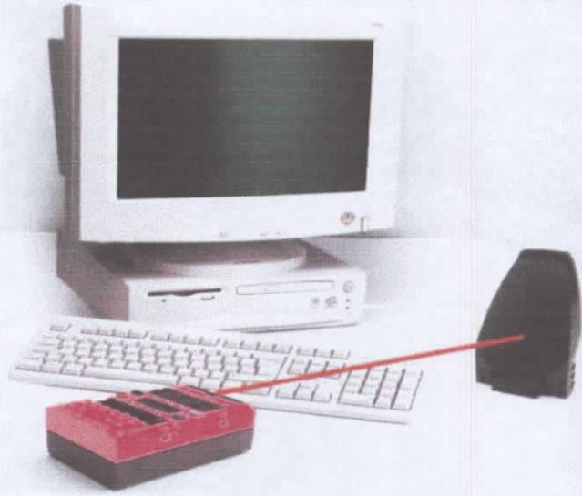
Figura 30 Torre IR en transmisión con el RCX
