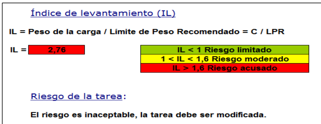
Figura VIII. Resultado de índice de levantamiento Fuente: (Nogareda y Canosa, 2012)
