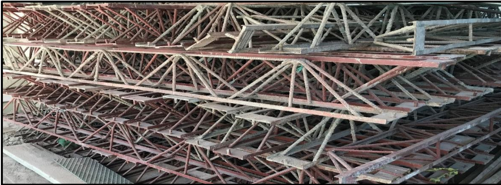
Fotografía 3: Viguetas metálicas de 3 metros.
