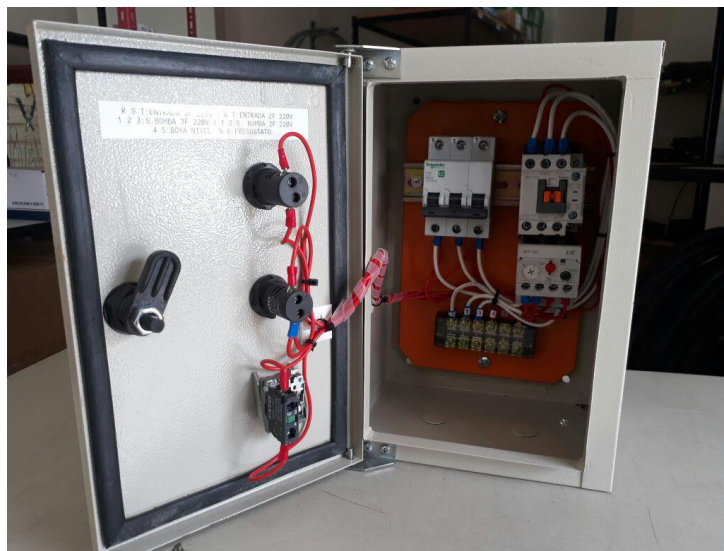
Figura 6: Tablero Eléctrico de gama baja para sistema de bombeo
