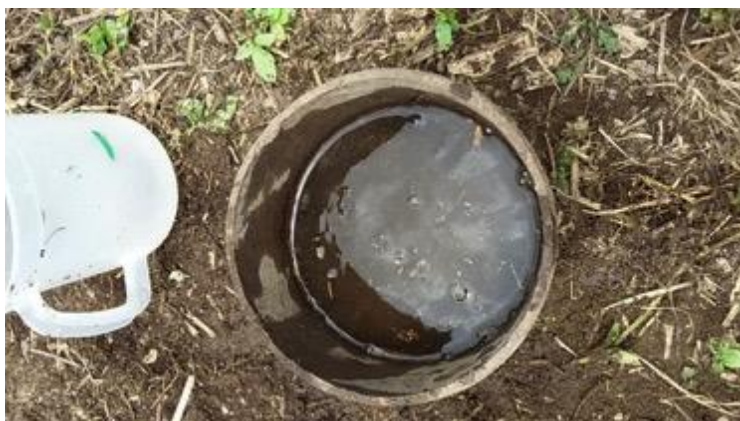
Figura 6. Prueba de Infiltración. Lote 3
