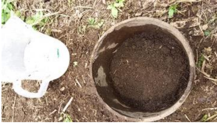
Figura 4. Prueba de Infiltración. Lote 1
