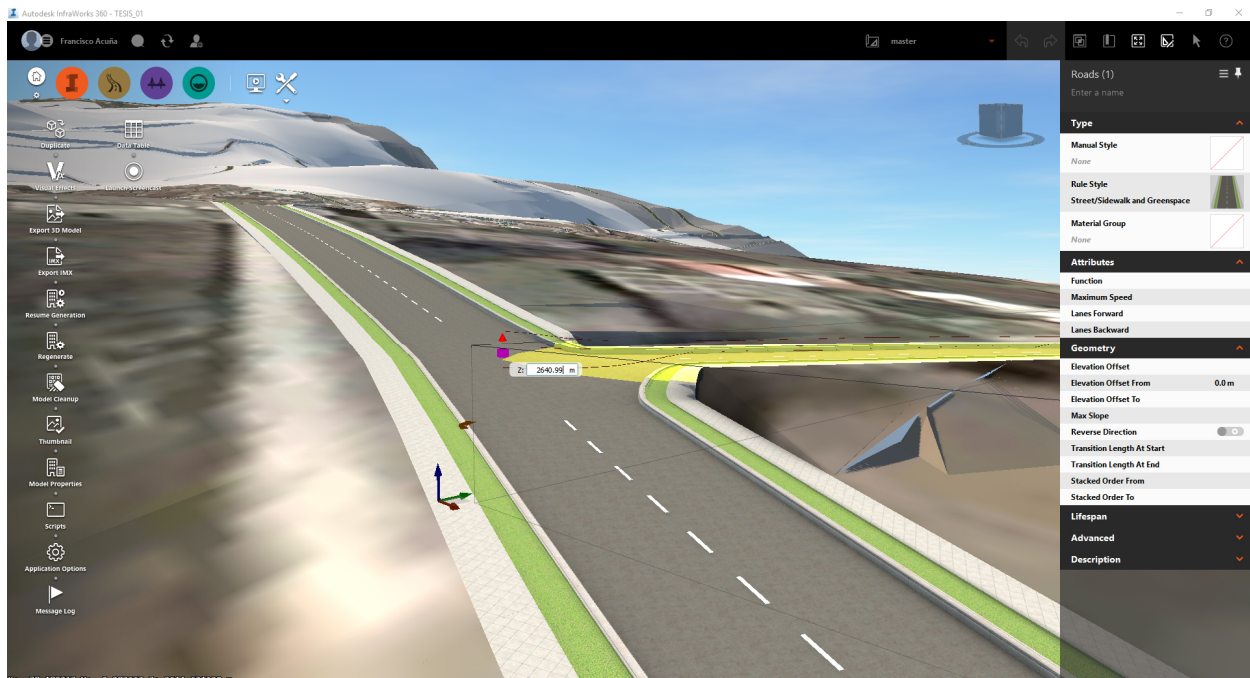
Ilustración 12. Alternativa de proyecto en nivel conceptual bajo metodología BIM. Fuente: Acuña Xavier
