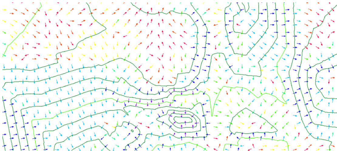
Ilustración 27. Análisis de dirección de pendientes de superficie TIN. Fuente: Acuña Xavier
