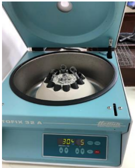
Fotografía 10: Centrifugación de muestras a 339.593 g 5 minutos
