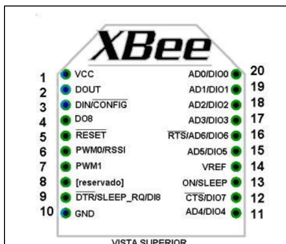
Figura 4.8 Diagrama de los pines Módulo Xbee
