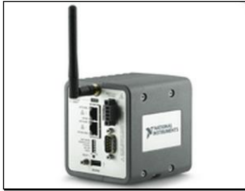
Figura 2.4 Gateway IEEE 802.15.4 de 2.4 Ghz
