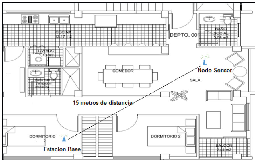
Figura 4.34 Distancia entre Nodo sensor y Estación Base
