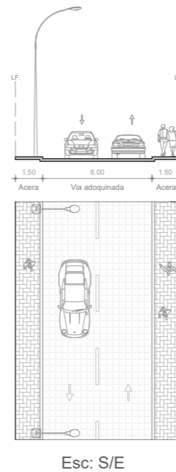
Figura 59. Perfiles vial existente, B-B'
