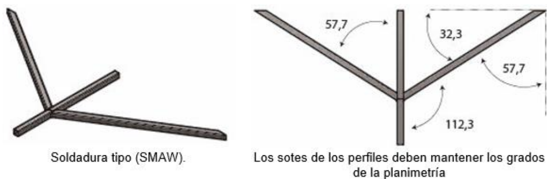
Gráfico 42. Detalles tiro triangular con barra centrar
