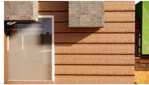
RECUBRIMIENTO DE PARED DE BARRO ESPESOR 2 cm
