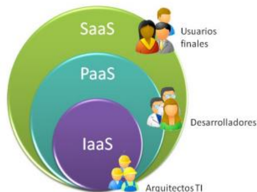
Figura 4. Capas de los servicios ofrecidos en Cloud Computing
