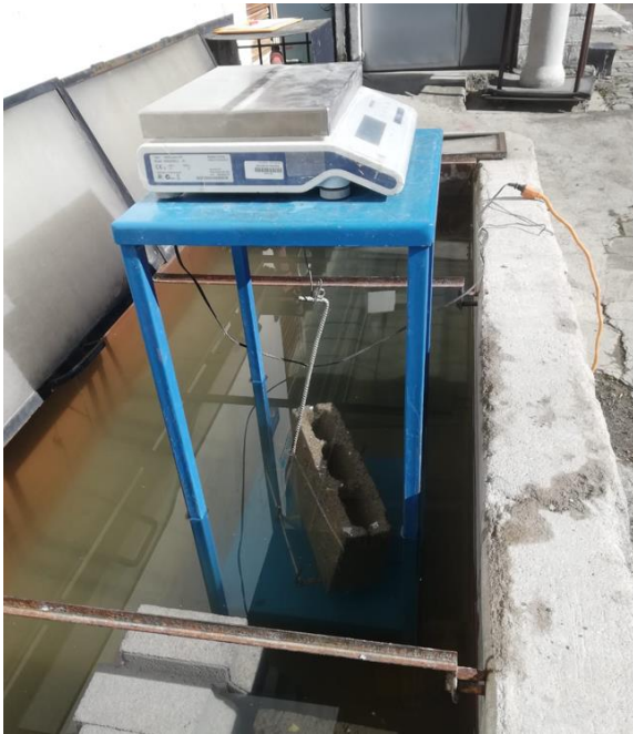
Ilustración 25. Determinación de la masa sumergida
