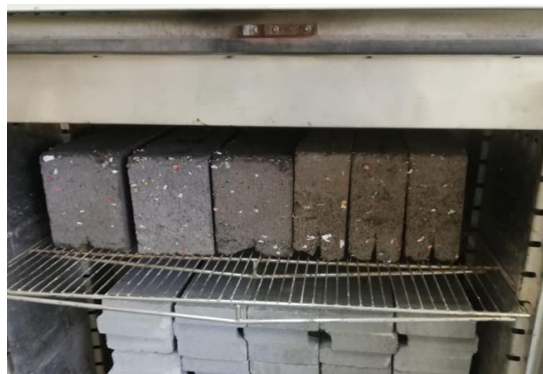
Ilustración 27. Colocación de bloques en el horno
