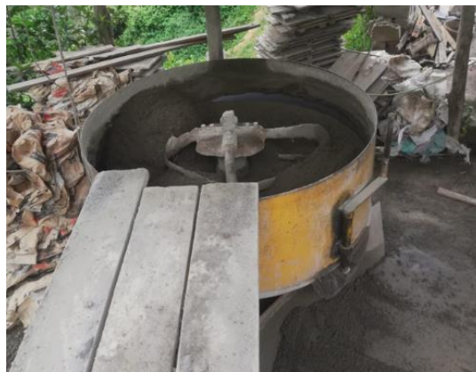
Ilustración 20. Maquinaria de mezcla
