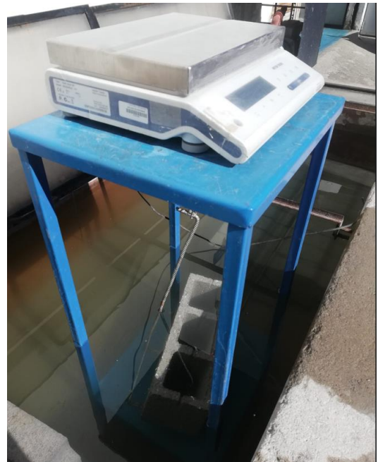
Ilustración 25. Determinación de la masa sumergida
