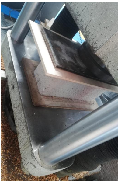
Ilustración 24. Resultados de bloques sometidos a cargas
