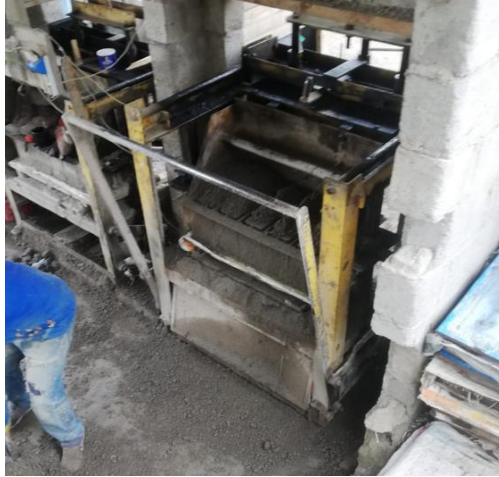
Ilustración 21. Prensadora de bloques
