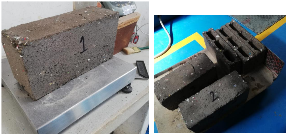
Ilustración 26. Determinación de la masa saturada
