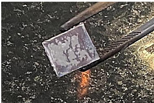
Figura 2 Placa de acero inoxidable luego del enjuague con agua Mili-Q esteril, con adherencia de biopelícula
