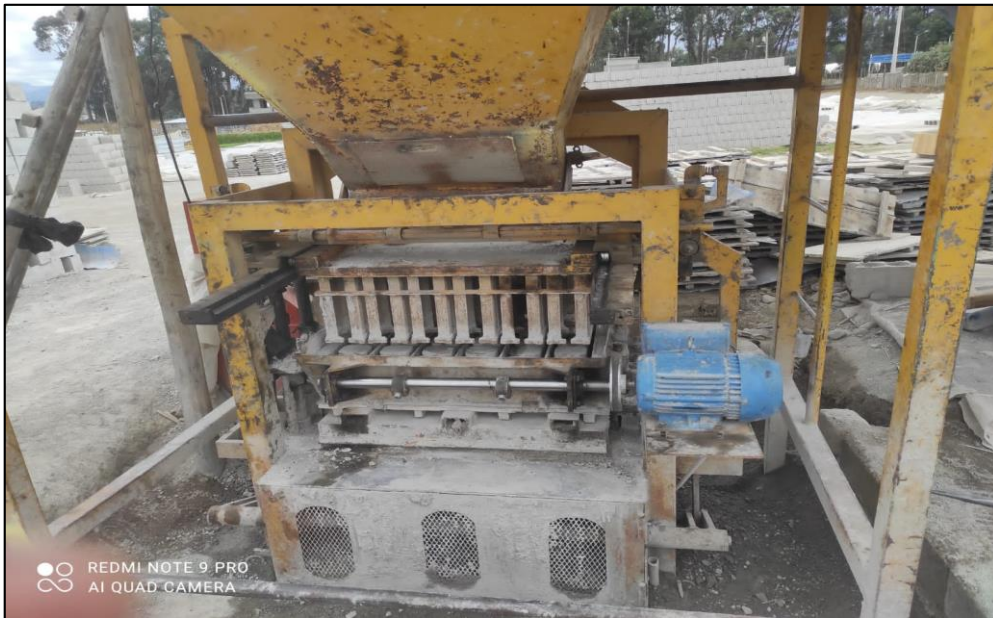
Figura 9.- Esquema de máquina vibro compactadora.
