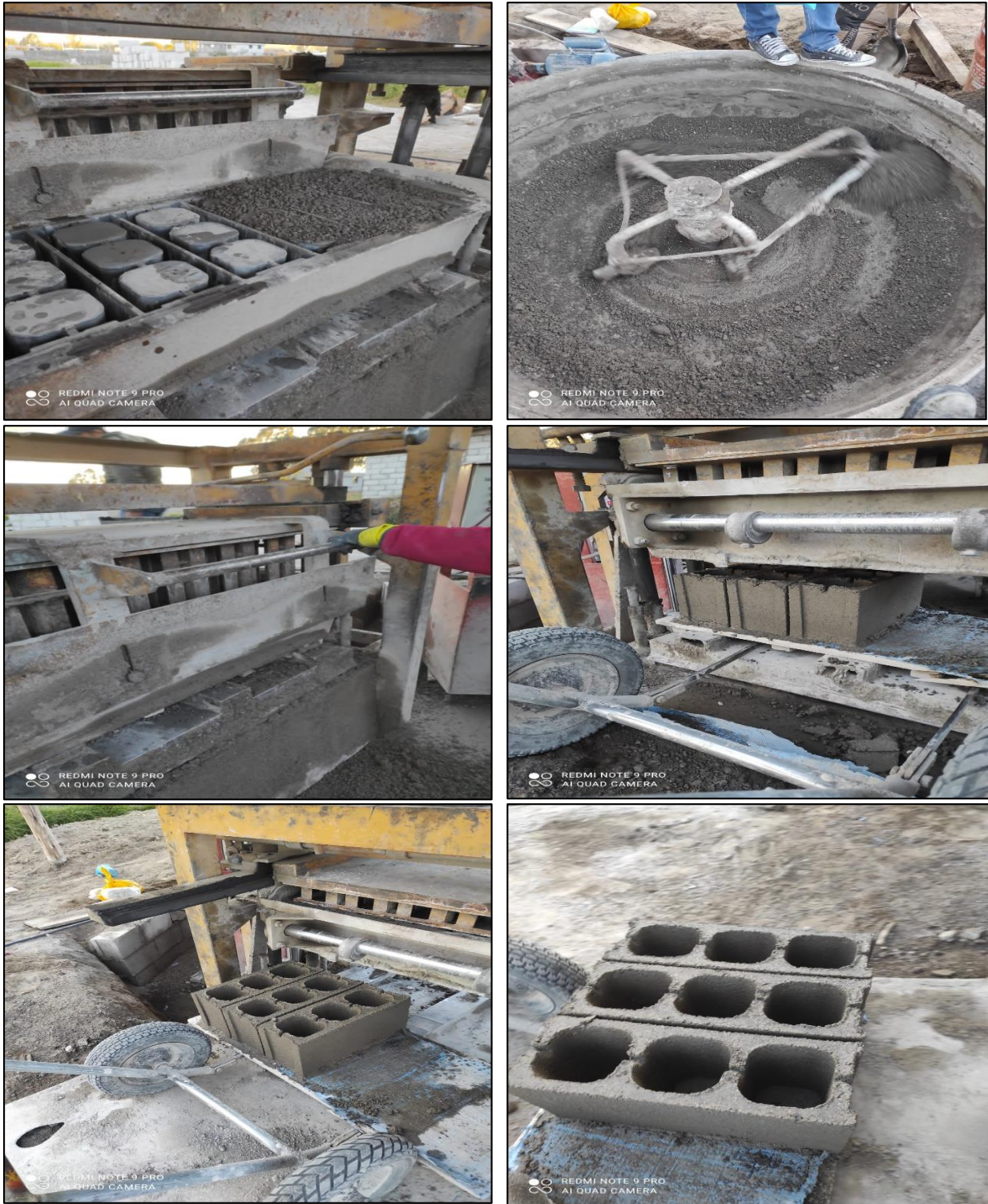
Figura 10.- Distintas fases del proceso de fabricación de bloques.
