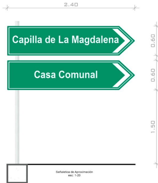
Figura 30 Señalética de aproximación con dos indicadores
