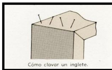
Imagen 2.41. Método inglete con clavos
