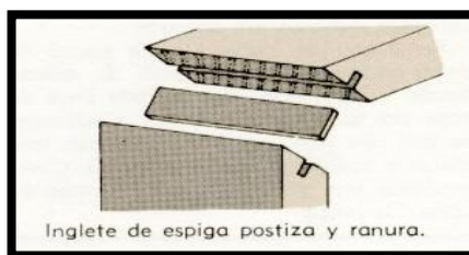
Imagen 2.42. Método inglete de espiga postiza
