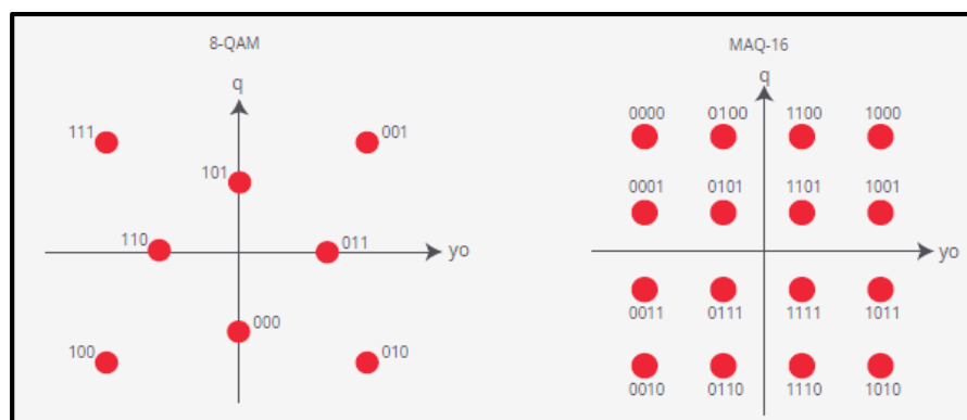
Figura 11: Diagramas de constelación de 8-QAM y 16-QAM – Fuente: (Keysight, 2019).
