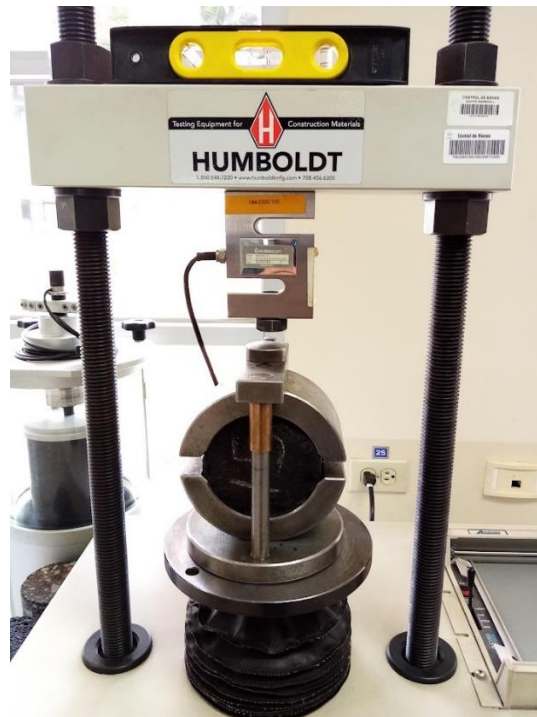
Ilustración 4.5 Briqueta fijada en máquina de ensayo
