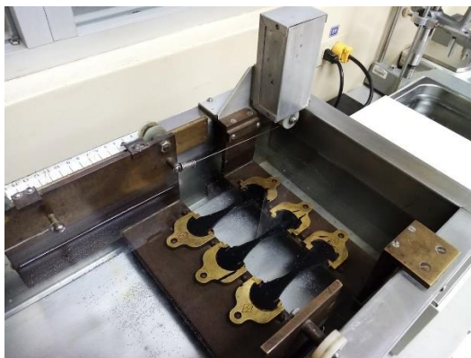
Ilustración 3.6 Ensayo de Ductilidad
