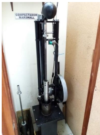
Ilustración 4.10 Máquina compactadora Marshall
