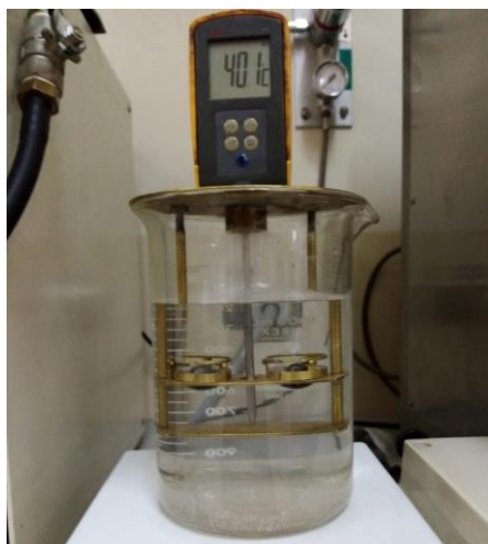
Ilustración 3.5 Ensayo de Anillo y Bola
