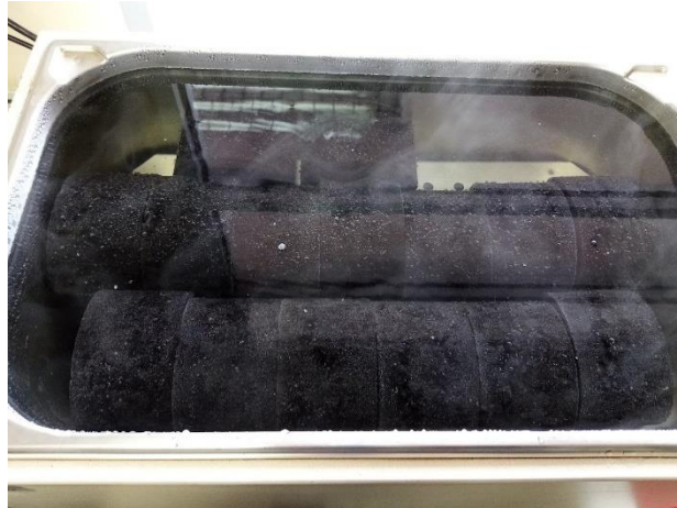
Ilustración 4.3 Briquetas sumergidas para ensayo Marshall
