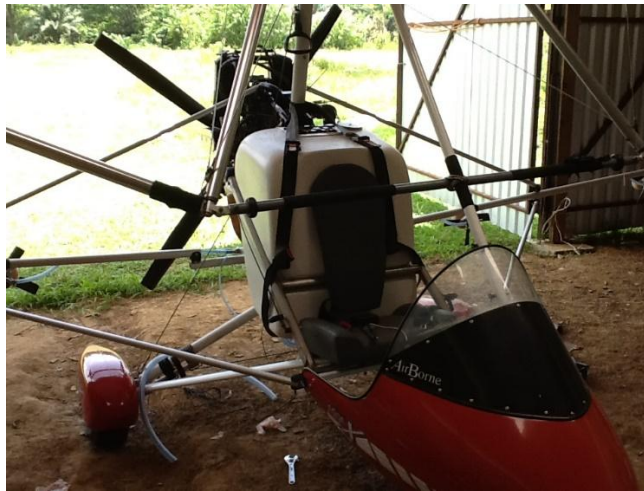
Figura 1. Avión Ultraligero instalado la bomba de fumigación
