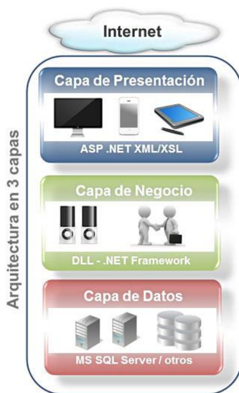
Ilustración 6 - Arquitectura tres capas
