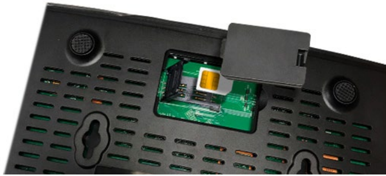
Figura 141. Ubicación de chip celular en el router (D-Link, 2018).
