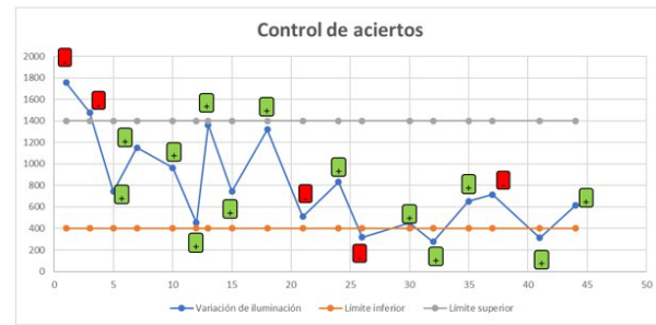
Figura 11. Control de aciertos del robot asistencial relación a la iluminación de la cabina
