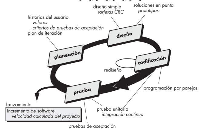
Fig. 2. El proceso de la programación extrema [15].
