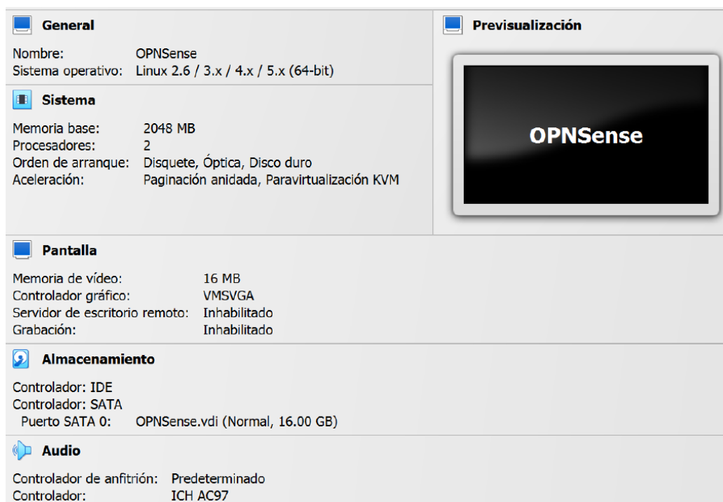
Figura 20. Configuración de máquina virtual OPNSense en Virtualbox.
