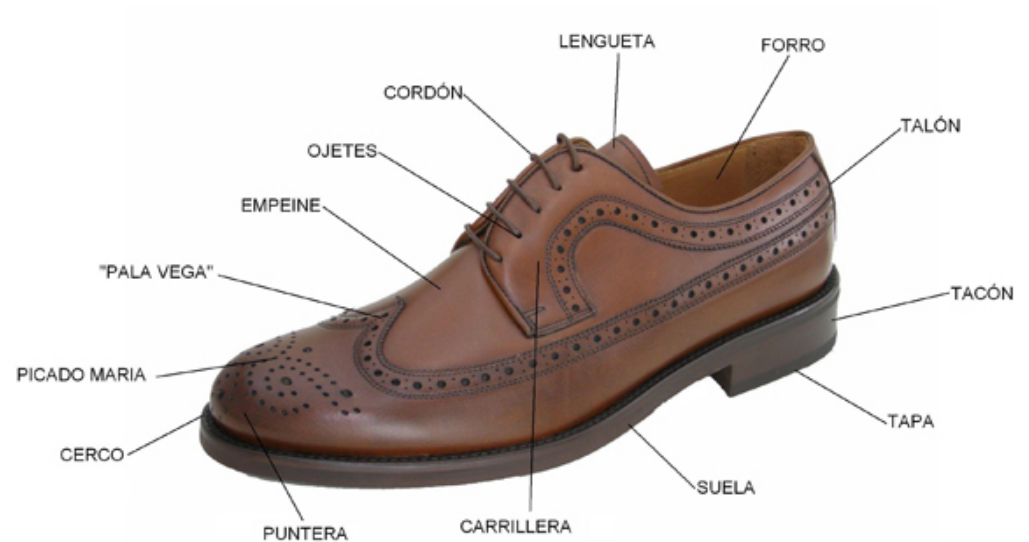
Gráfico 2.2: Partes del calzado perspectiva
