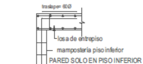
ARMADURA DE DINTEL Y ALFÉIZAR ESCALA 1:20
