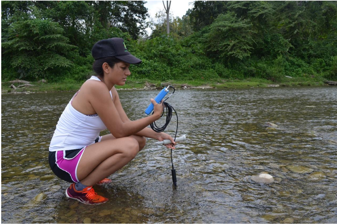
Imagen 10.- Medida de parámetros físico-químicos in situ con sonda
