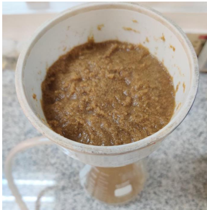
Fig 18. Filtrado al vacío del material orgánico después de la activación, previo para el empaquetamiento en los filtros.
