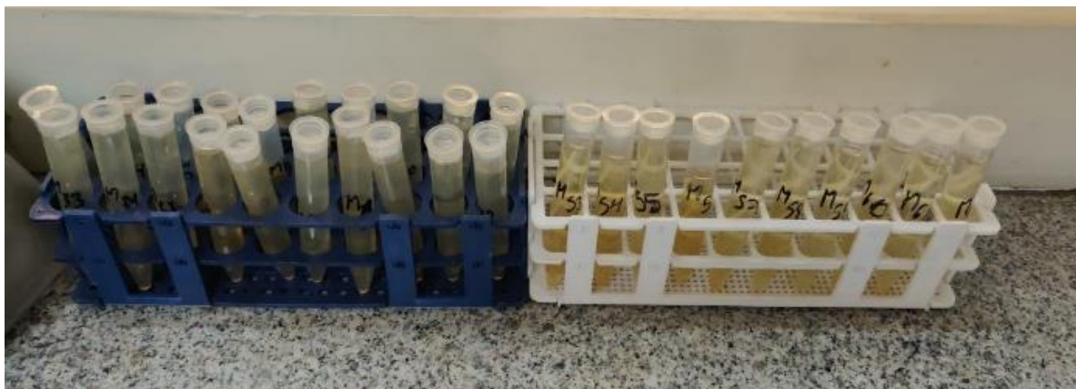
Fig 20. Recolección del percolado en viales previo a su lectura en el equipo de espectroscopia de absorción atómica.
