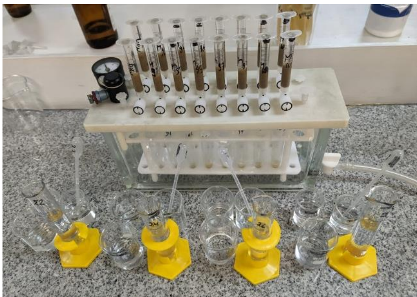
Fig 19. Colado de 25 mL de volumen de las diferentes concentraciones de metales pesados a través de una cámara al vacío con la adaptación en jeringas de 3 mL como cartuchos.
