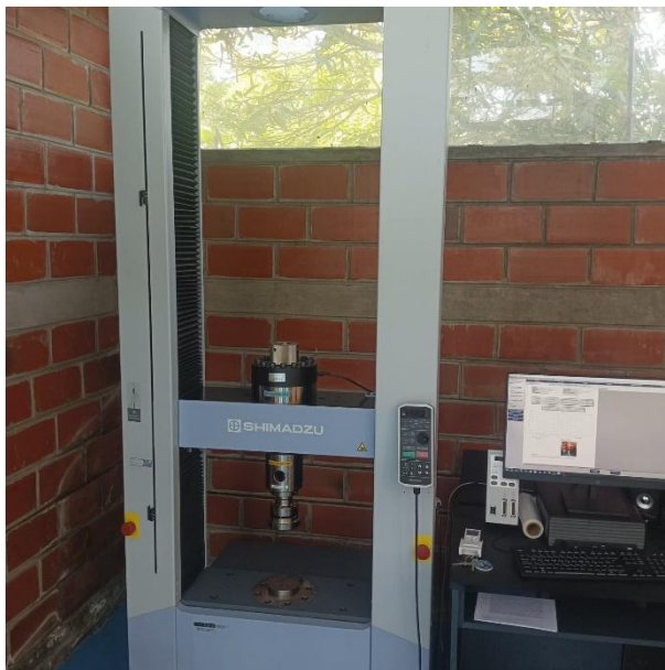
Máquina universal de ensayos SHIMADZU
