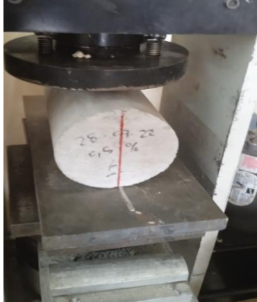
Ilustración 5.7 Ensayo de tensión en muestras cilíndricas de hormigón
