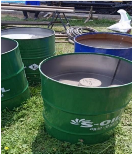
Ilustración 4.7 Curado de las muestras (cilindros y vigas) con y sin residuos de botellas PET
