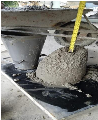
Ilustración 4.4 Asentamiento de la mezcla sin residuos de envase de botella
