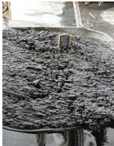
Ilustración 4.3 Temperatura de la mezcla sin residuos de envase de botella
