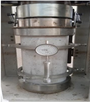
Ilustración 5.5 Ensayo para determinar el módulo de elasticidad del hormigón
