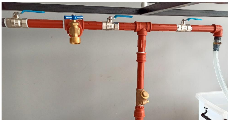
Figura 93. Sistema de Regulación del Caudal.
