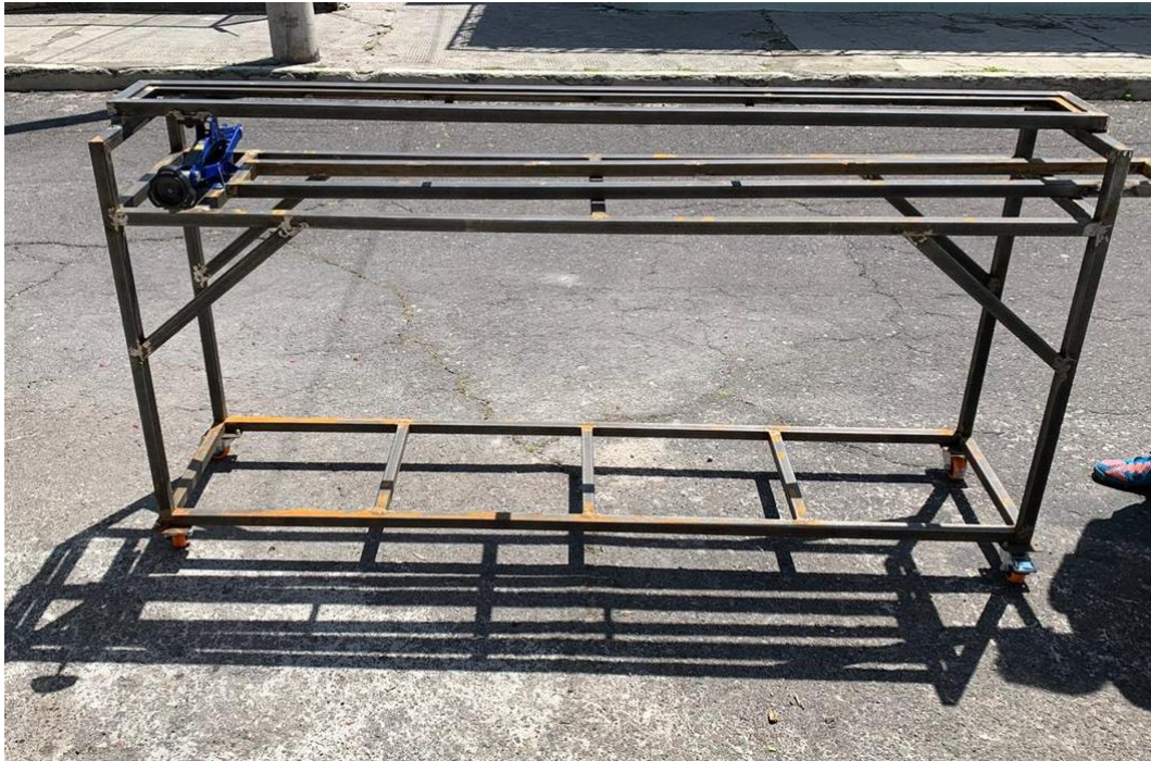
Figura 70. Soporte del Canal.
