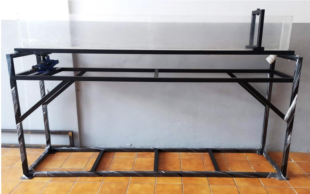
Figura 72. Soporte del Canal y Marco de la Compuerta Pintados.
