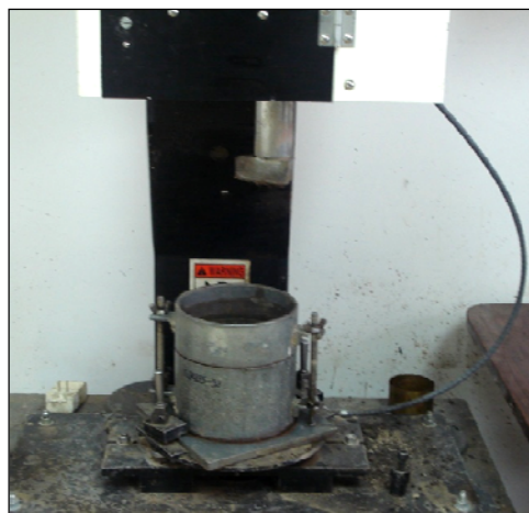
Fotografía No. 3.1 Proctor modificado
