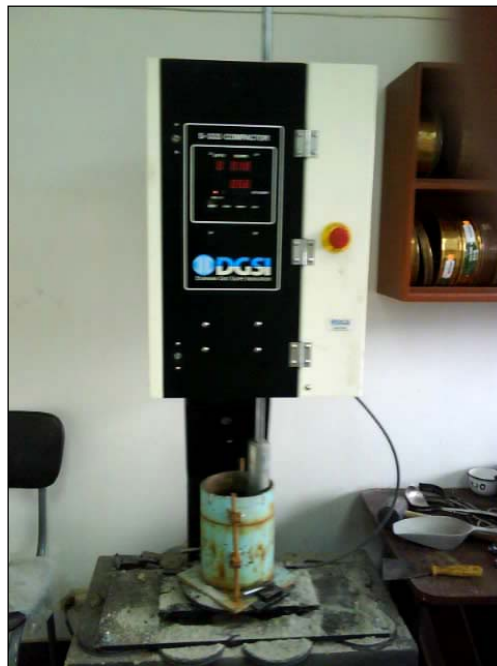
FOTOGRAFÍA NO. 3.5 ENSAYO CBR
