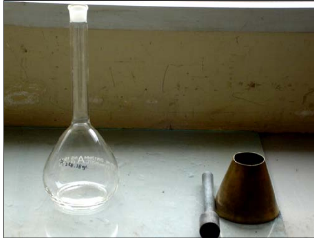
FOTOGRAFÍA NO. 2.5 DENSIDAD DEL AGREGADO FINO
