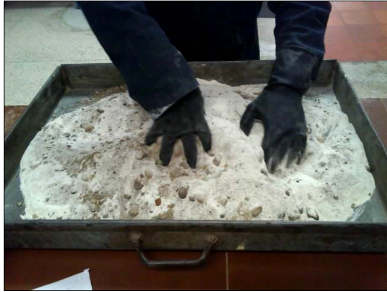
FOTOGRAFÍA NO. 3.4 MEZCLA DE SUBBASE CON DESECHO DE PVC
