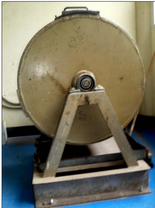
FOTOGRAFÍA NO. 2.9 DESGASTE A LA ABRASIÓN CON LA MÁQUINA DE LOS ÁNGELES
