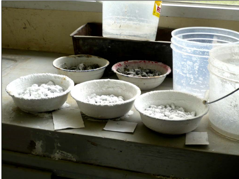
FOTOGRAFÍA NO. 2.8 DURABILIDAD DE LOS AGREGADOS A LA ACCIÓN DE SULFATO DE SODIO
