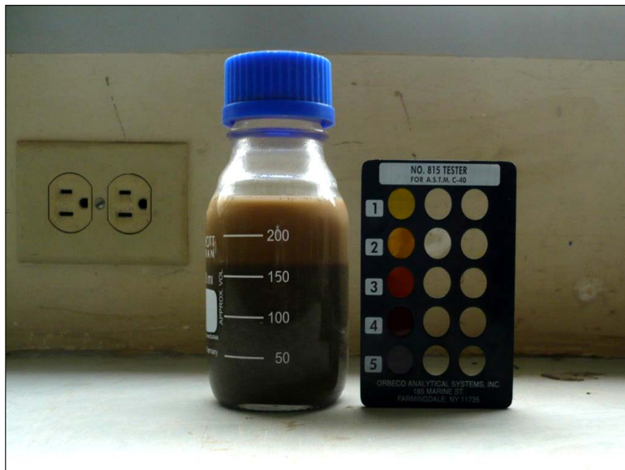
FOTOGRAFÍA NO. 2.4 MATERIAL EN SOLUCIÓN Y ESCALA DE COLOR NORMALIZADO
