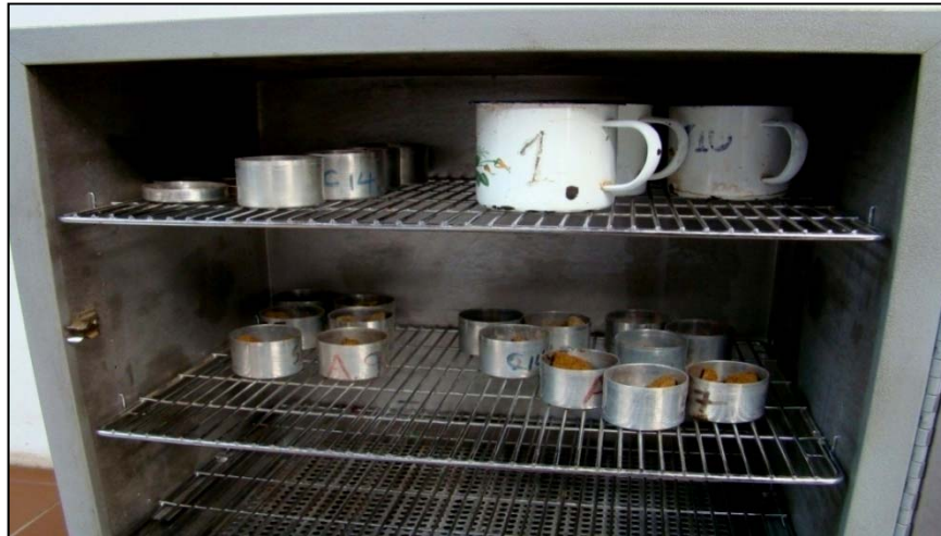
FOTOGRAFÍA NO. 2.3 CONTENIDO DE HUMEDAD
