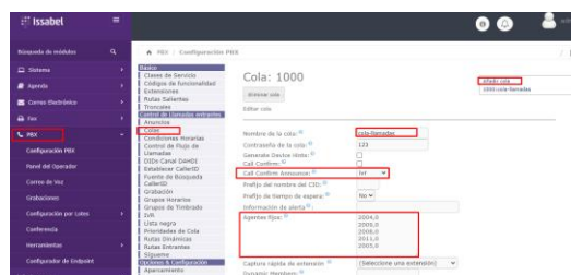
Fig.A1. 55 Configuración del apartado PBX, parámetro Colas en el prototipo de CU de Issabel Fuente: (Issabel Project)
