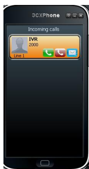
Fig.A2. 51 Call back redireccionando la llamada hacia la extensión configurada IVR (2000). Fuente: (Issabel Project)
