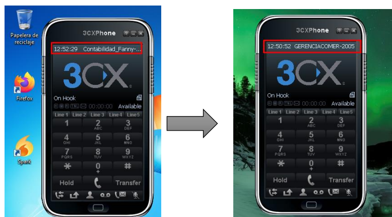
Fig.A2. 36 Marcado de llamada entre las extensiones 2007 y 2005 en la PBX de Issabel. Fuente: (Issabel Project)
