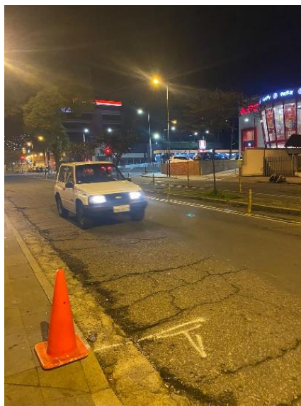
Imagen 58 Calibración con equipo ROMDAS por diferentes vías de calibración
