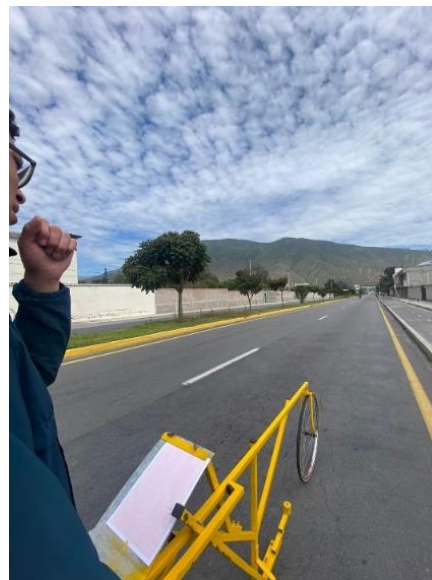
Imagen 48 Medición MERLIN (Mango Inga)
