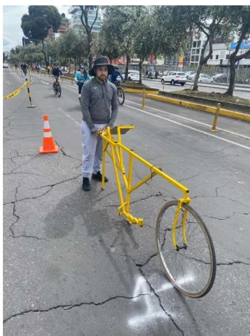
Imagen 44 Medición MERLIN (Av. Amazonas)
