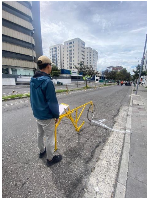
Imagen 46 Medición MERLIN (Av. Colón)
