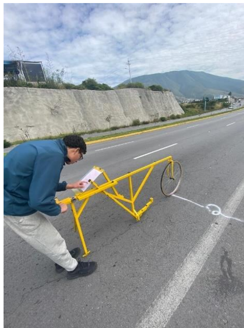
Imagen 50 Medición MERLIN (Simón Bolívar)
