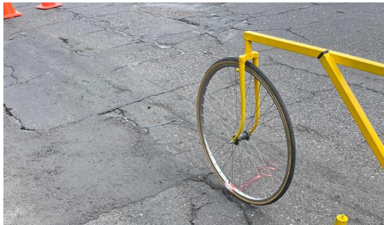
Imagen 18 Marca en la rueda MERLIN
