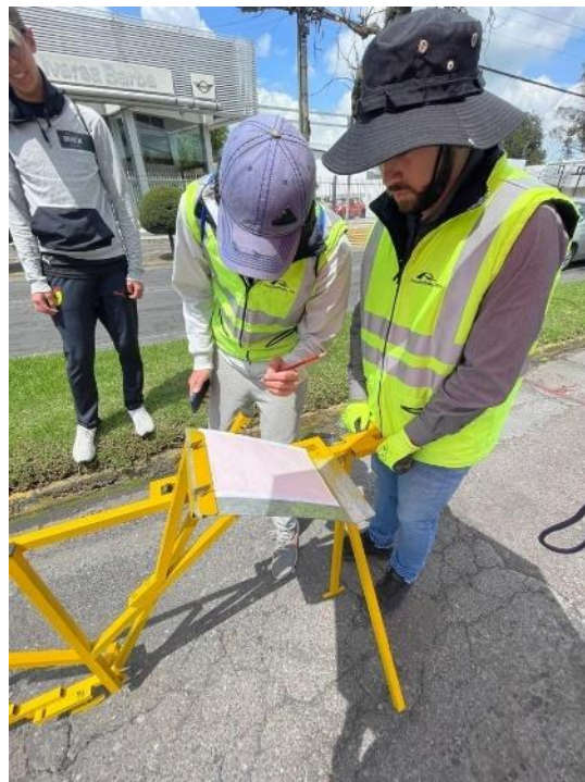
Imagen 40 Medición MERLIN (Galo Plaza Lasso, tramo1)
