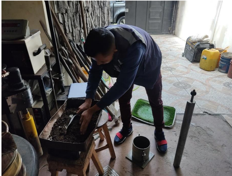
Imagen 11: Realización de ensayo Proctor
