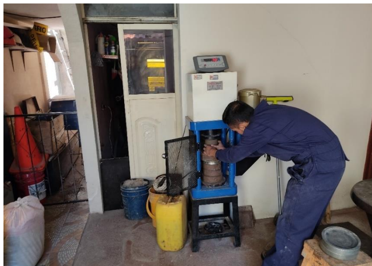
Imagen 13: Realización de ensayo de compresión simple a las muestras estabilizadas.
