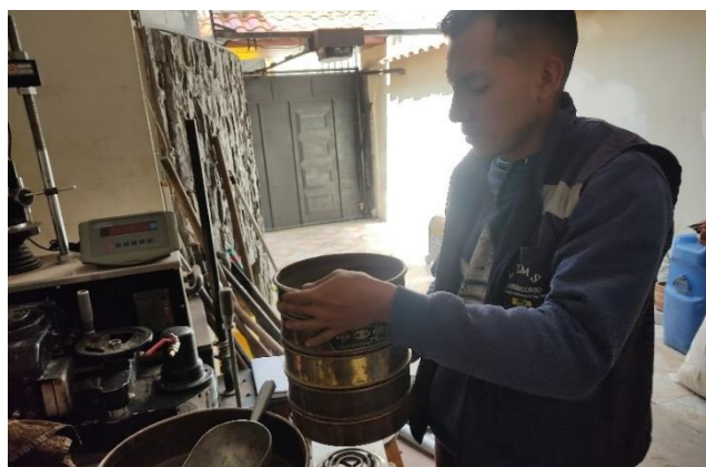
Imagen 8: Tamizado manual del suelo natural
