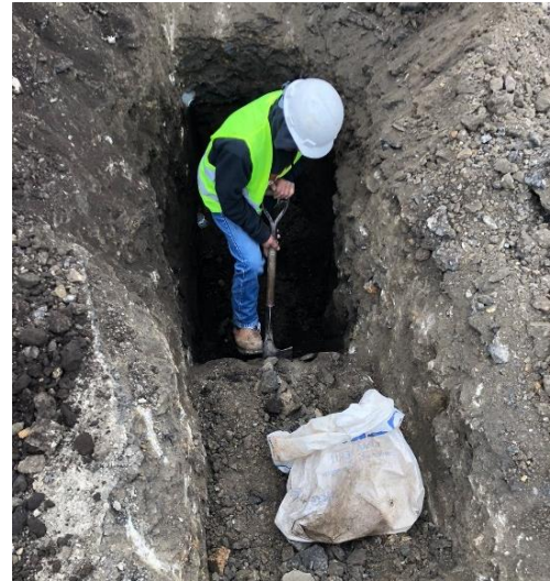
Imagen 3:Recoleccion de muestras alteradas.
