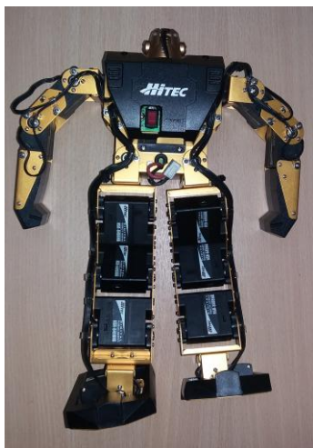
Ilustración 3. 9 Ubicación de la Placa MCR3024 en la espalda del robot. Fuente: (Autor, 2015)
