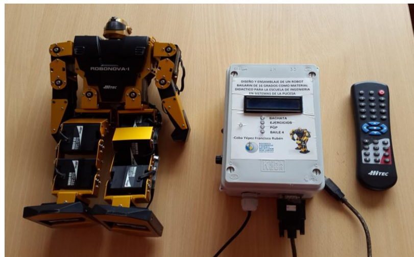
Ilustración 4. 1 Hardware armado y construido. Robot-Modulo Infrarrojo-Control Remoto.
