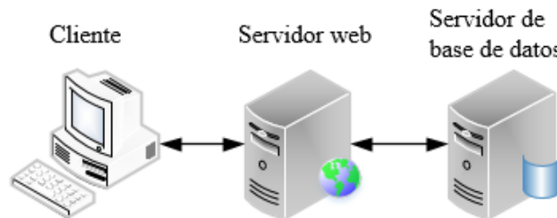
Figura 4.- Arquitectura de aplicaciones web – dos niveles
